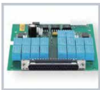
HM8112-3S: мультиметр со встроенным коммутатором каналов измерения (8+1 каналов, 2- и 4-проводных)
