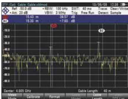
Измерение расстояния до места повреждения (DTF)
