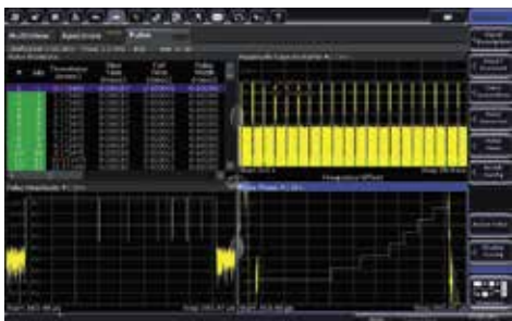
Опций FSW-K6 и K6S позволяют одним нажатием кнопки производить анализ импульсных сигналов радиолокационных систем
