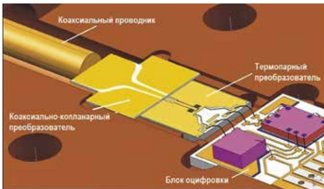
Входной каскад ВЧ-тракта с коаксиально-копланарным преобразователем
