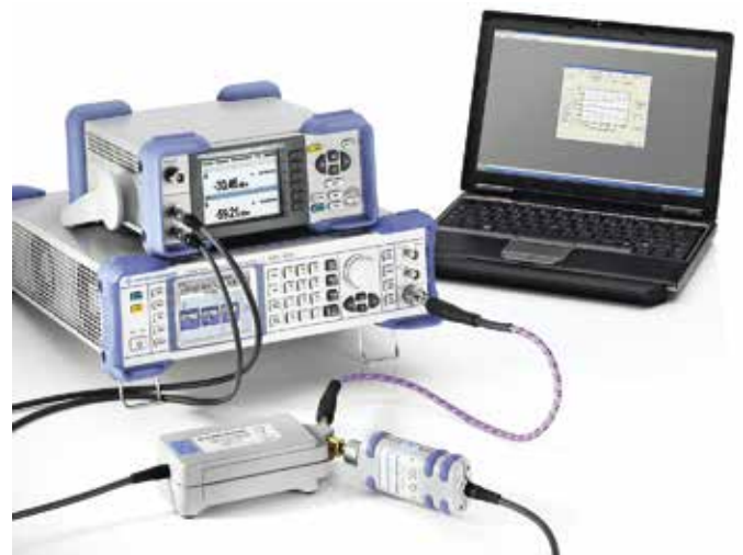
Измерительная установка для калибровки преобразователя мощности NRP-Z55
