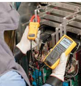
Комбинированный комплект с промышленным регистрирующим мультиметром 289/FVF истинных среднеквадратичных значений с функцией TrendCapture
