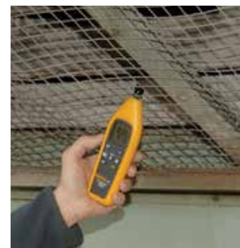
Контроль уровней влажности воздуха в помещении с помощью Fluke 971
