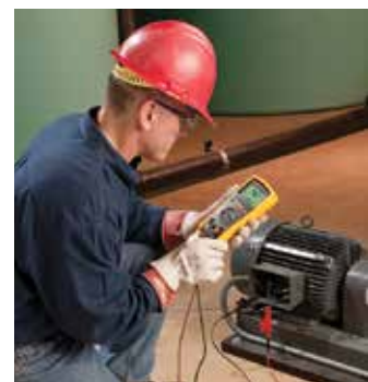
Проверка малых сопротивлений и целостности заземления соединений и обмоток электродвигателей
