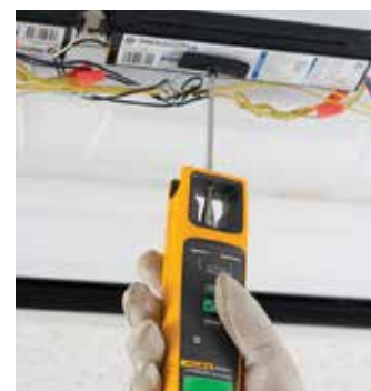
Простое определение работоспособности балластного сопротивления
