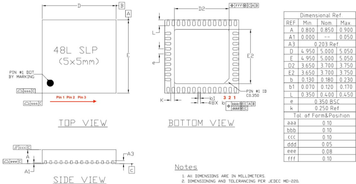
图 6: QFN48 (5x5 mm) 封装
