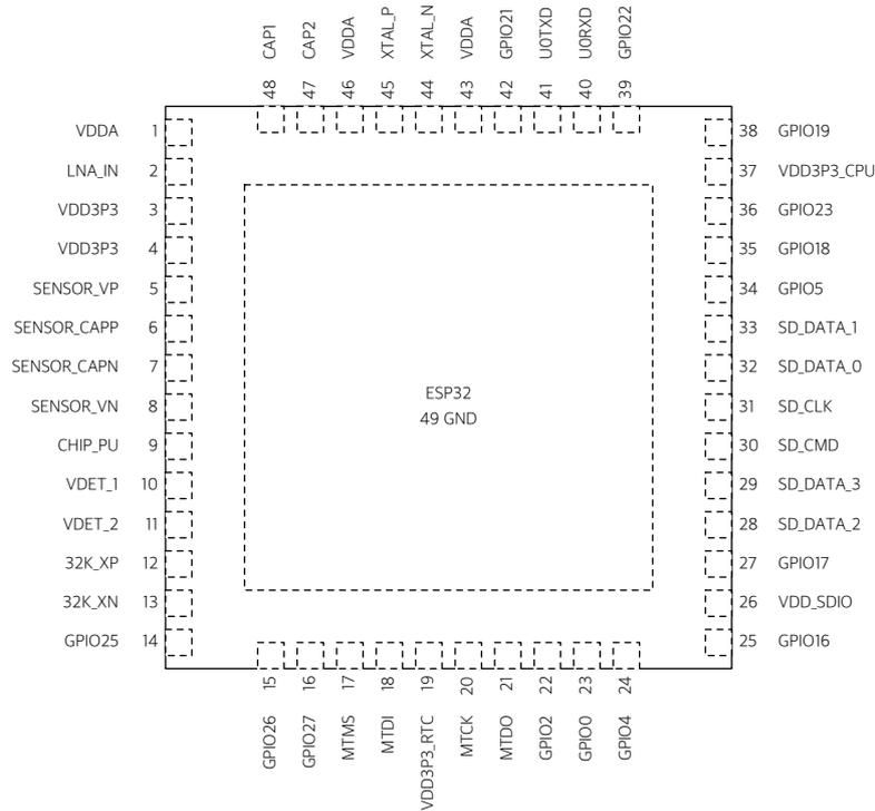
图 3: ESP32 管脚布局 (封装为 QFN 5\*5)
