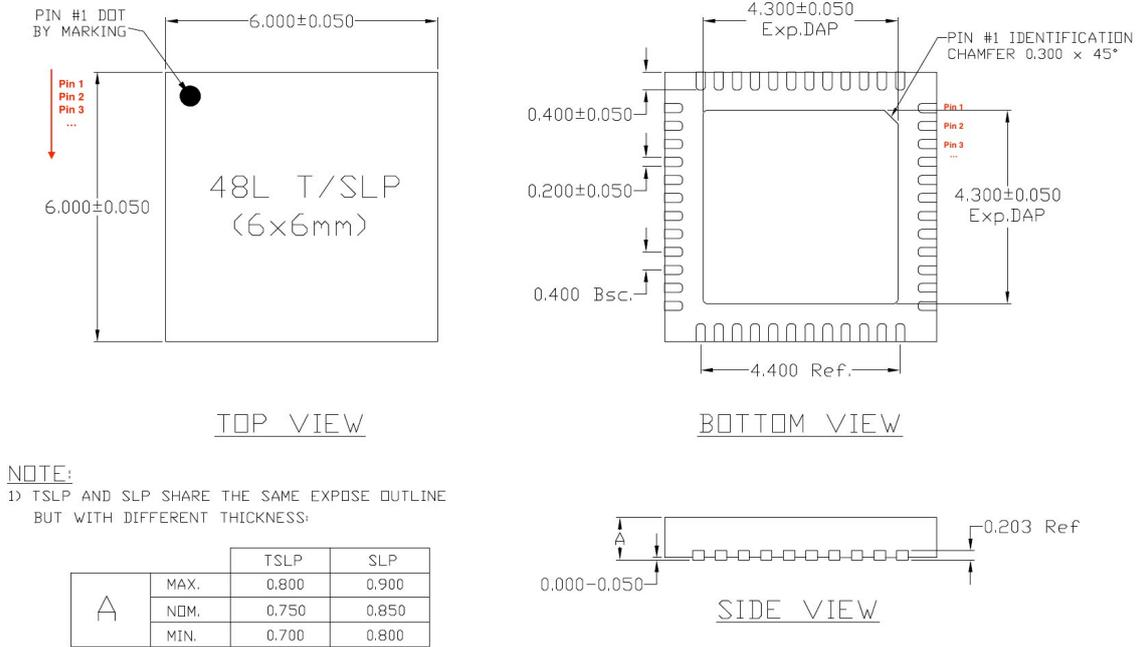
图 5: QFN48 (6x6 mm) 封装
