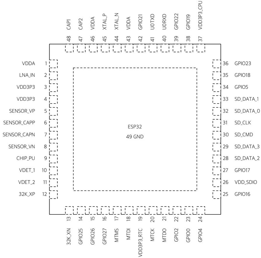
图 2: ESP32 管脚布局 (封装为 QFN 6\*6)
