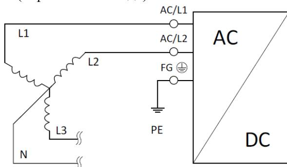
Рекомендуется использование предохранителя или автоматического выключателя для входа AC/L2. Внутренняя защита входа AC/L2 отсутствует.
