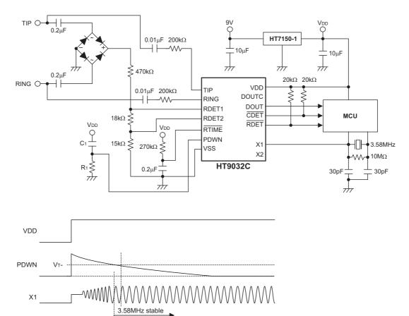
Note: reference  $C_1=0.1\mu F R_1=81k\Omega$
