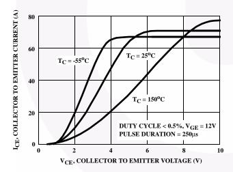
FIGURE 5. COLLECTOR TO EMITTER ON-STATE VOLTAGE
