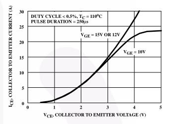
FIGURE 16. COLLECTOR TO EMITTER ON-STATE VOLTAGE
