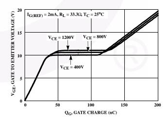
FIGURE 14. GATE CHARGE WAVEFORMS
