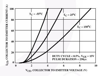
FIGURE 6. COLLECTOR TO EMITTER ON-STATE VOLTAGE
