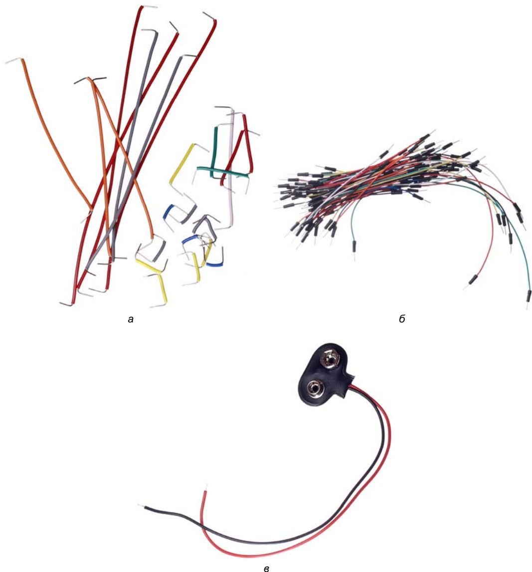
Рис. Ц-2.4. Жесткие переключки (а); гибкие переключки (б); колодка для батарейки типа «Крона» (в)
