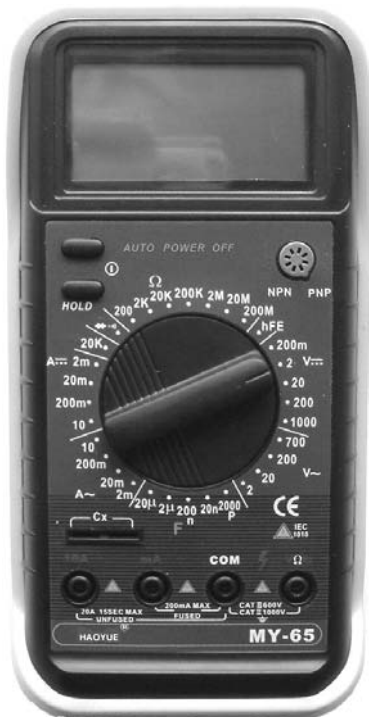
Рис. 2.1. Типовой мультиметр с дополнительной функцией измерения емкости
