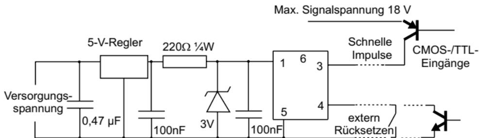
Bringen Sie den 100-nF-Kondensator (Übergangsunterdrückung) möglichst nahe am Gerät an.
