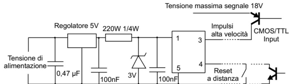
Montare il condensatore  $100\text{nF}$  (soppressione di transienti) il più possibile vicino all'unità.
