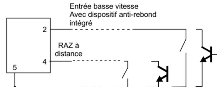
L'entrée de comptage basse vitesse (broche 2) doit toujours être utilisée pour contact sec, car elle seule dispose d'un dispositif anti-rebond.
