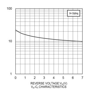
CAPACITANCE BETWEEN TERMINALS:C<sub>t</sub>(pF)
