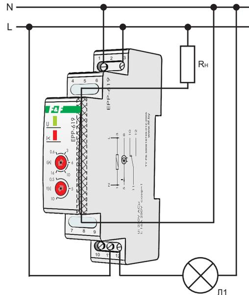
R<sub>n</sub> - Нагрузка подключаемая в контролируемую цепь
