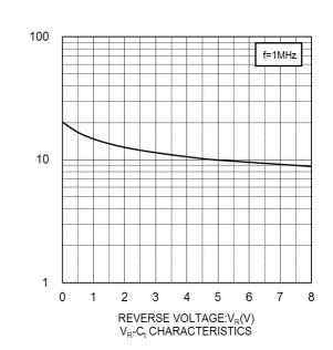
CAPACITANCE BETWEEN TERMINALS:C<sub>t</sub>(pF)
