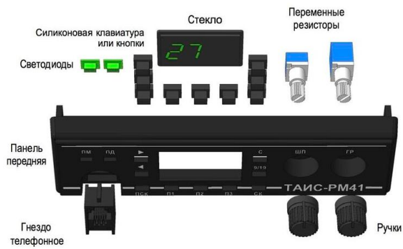
Элементы передней панели комплекта №1 деталей корпуса радиостанции
