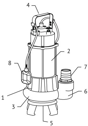
Насос представляет собой моноблочный агрегат, корпус которого разделен на гидравлическую часть (1) и электродвигатель (2). Однофазный асинхронный электродвигатель с конденсатором размещен в закрытом от попадания жидкости кожухе из нержавеющей стали.
