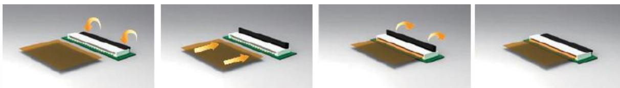
Рис. 2. Принцип работы защелки соединителя FPC
