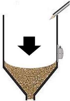
Lorsque la matière solide n'est plus en contact avec la membrane du détecteur de niveau, le contact s'ouvre et indique que le silo est vide.
