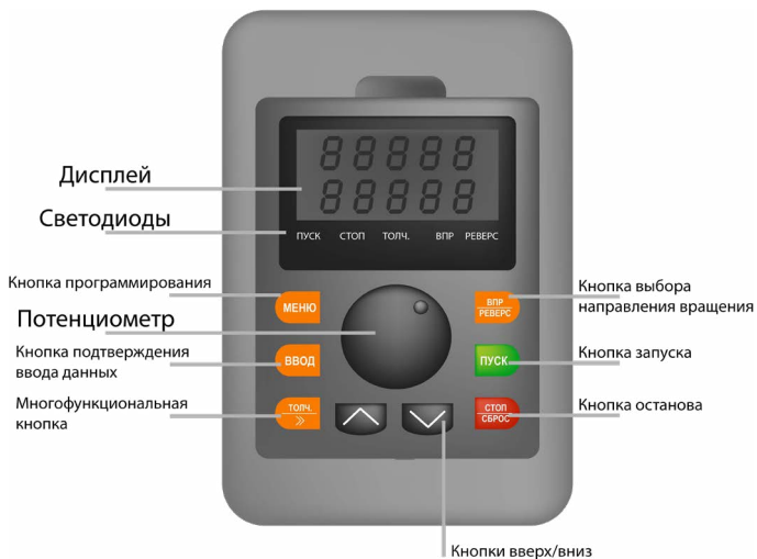
Рис. 5.1.1 Функции кнопок и светодиодов панели управления
