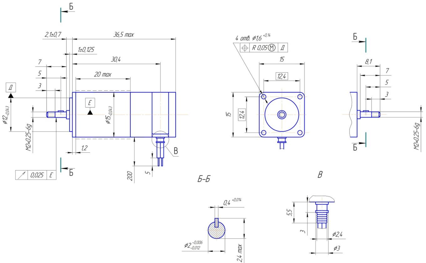
Чертеж 1 Габаритные, установочные и присоединительные размеры электродвигателей ДПР-2
