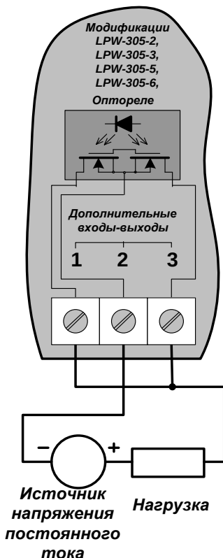
Рисунок Б.14 – Подключение импульсного выхода оптореле LPW-305 с креплением на DIN-рейке к цепи постоянного тока
