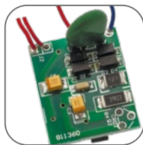
Современная электронная плата с повышенной защитой от импульсных помех
