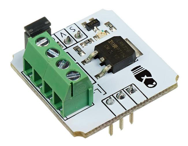
Микроконтроллер, такой как Arduino, не может напрямую управлять мощной нагрузкой. Его выходы могут отдавать только небольшой ток. Если вы хотите управлять мощной нагрузкой, такой как светодиодная лента, погружная помпа, или электродвигатель, вам необходим какой-нибудь ключ. Этот модуль как раз является ключом, выполненном на базе мощного полевого (MOSFET) транзистора.
