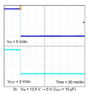
Figure 22. V<sub>IN</sub> ON/OFF Sequence
