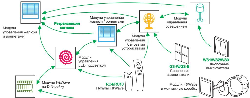
F & Wave - это семейство беспроводных радиоуправляемых устройств с диапазоном до 100 м \*. Приемники поставляются в версии для монтажа на DIN-рейку (корпус 1S) и в коробке для скрытого монтажа Ø60.
