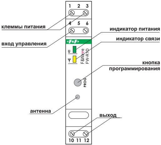
**Схема подключения модуля FW-R1D**
