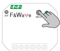
После подключения к сети питания приемника (исполнительного устройством F&Wave) нажать и удерживать кнопку PROG до тех пор, пока не включится нагрузка на выходе и погаснет индикатор связи с символом
