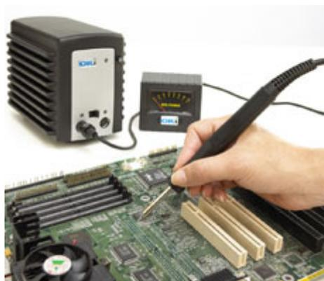
Для получения качественного паяного соединения контакт должен быть нагрет с определенной скоростью, так чтобы сначала активизировался и прореагировал флюс, а уж затем произошло растекание припоя и формирование соединения.
