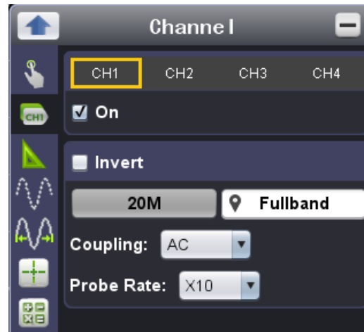
Рисунок. Настройка четырехканального осциллографа
