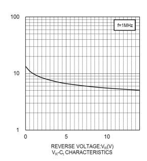
CAPACITANCE BETWEEN TERMINALS:C<sub>t</sub>(pF)
