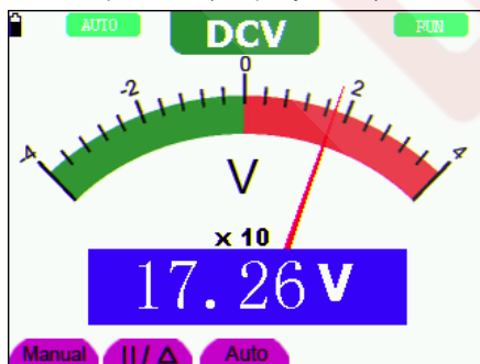
Рисунок 31. Измерение постоянного напряжения
