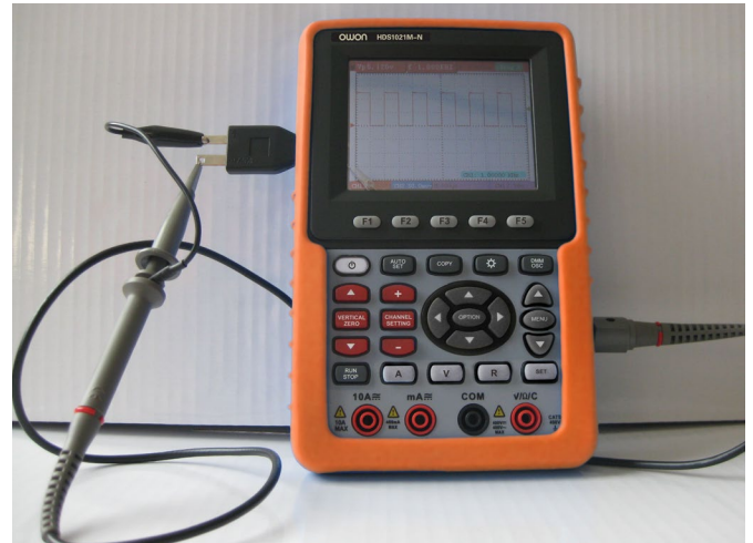
Рисунок 3. Подсоединение тестового прямоугольного сигнала
