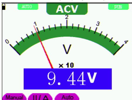
Рисунок 32. Измерение переменного напряжения
