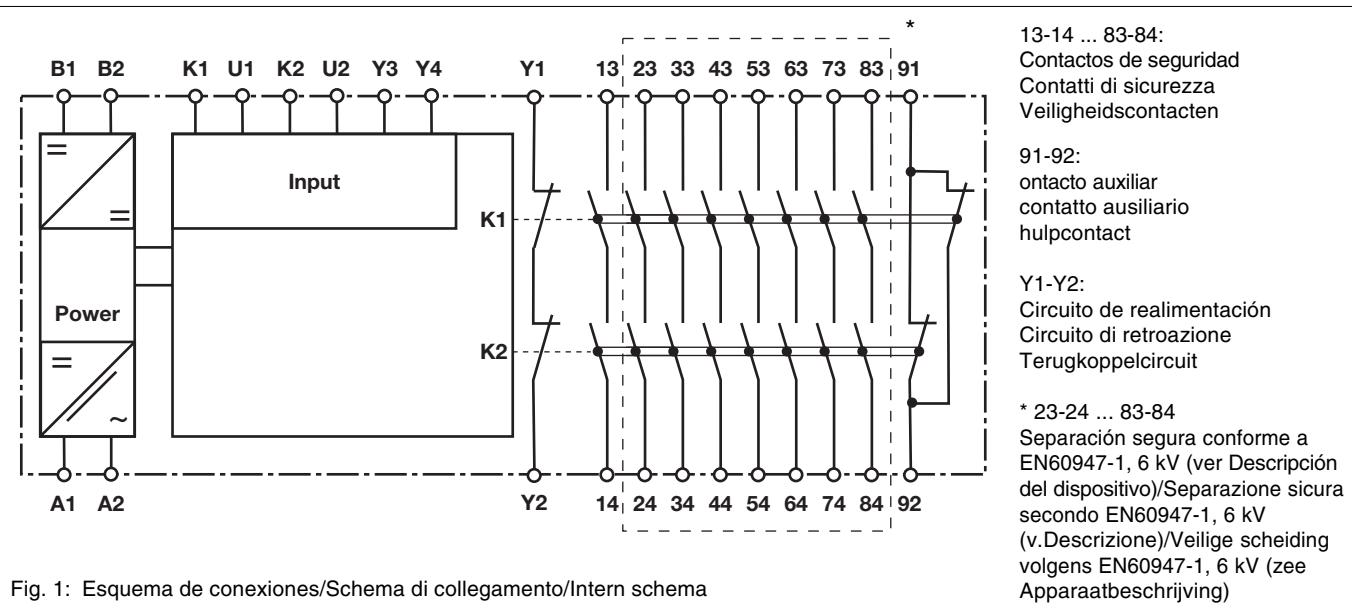
Fig. 1: Esquema de conexiones/Schema di collegamento/Intern schema
