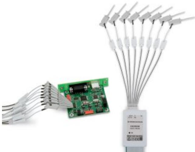
Рис. 12.1 – Опциональный логический пробник HO3508
