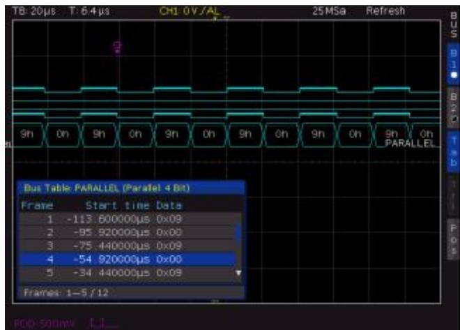
Рис. 13.3 – Пример параллельной шины данных с таблицей шины данных
