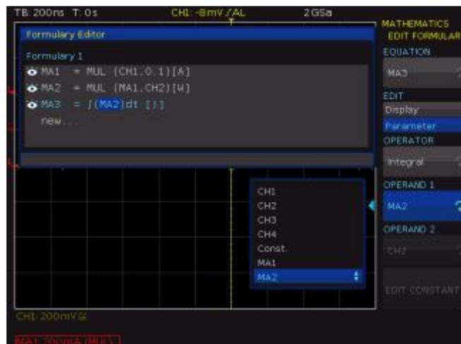
Рис. 9.6 – Определение формулы для вычисления мощности
