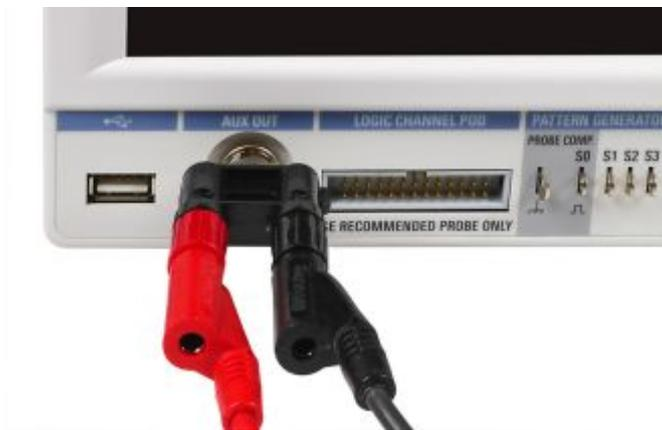
Рис. 9.9 – Адаптер HZ20, подключенный к разъему AUX OUT
