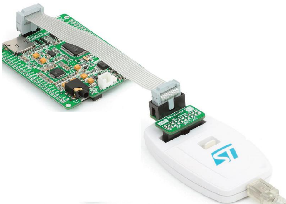
Рисунок 3-13: Подключение программатора ST-LINK™ V2
