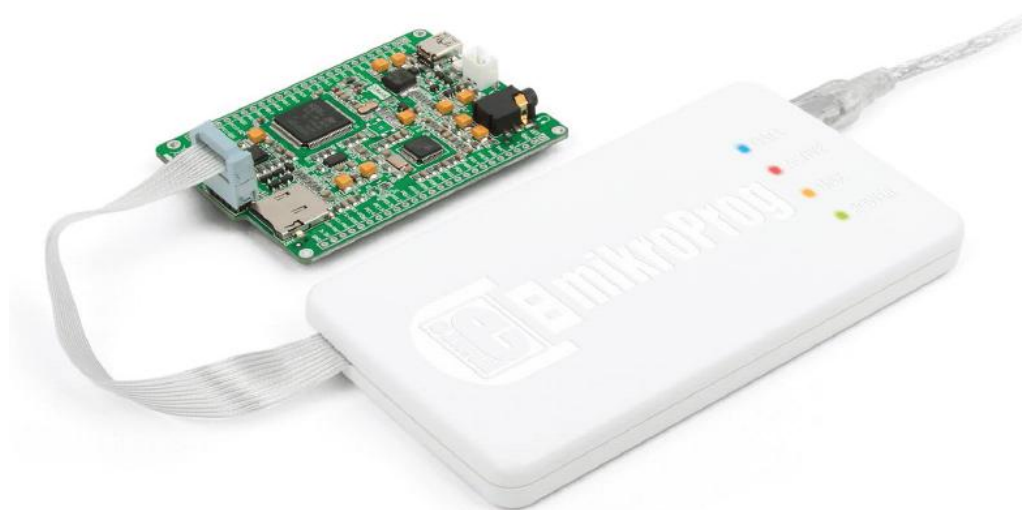
Рисунок 3-10: Подключение mikroProg™ к mikromedia™
