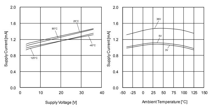
Figure 30. 回路電流一電源電圧特性
