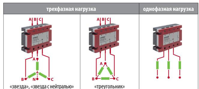
\* Другие известные в России ТТР имеют всего две коммутируемых фазы, а третья фаза, как правило, зашунтирована перемычкой. Такие реле не позволяют коммутировать однофазную нагрузку либо трехфазную по схеме «Звезда с нейтралью».
