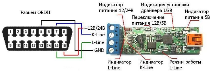
Общий вид устройства и его подключение
