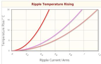
CGB2A3X5R1A474K033BB(100kHz) CGB2A3X5R1A474K033BB(500kHz) CGB2A3X5R1A474K033BB(1MHz)
