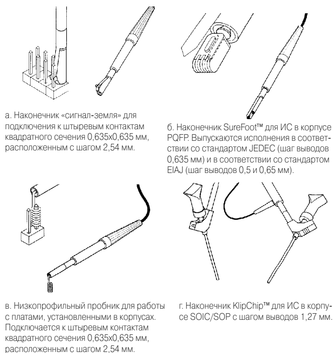
Рис. 2.16. Примеры наконечников для малогабаритных пробников. Некоторые наконечники значительно упрощают подключение к миниатюрным контактам и могут повышать точность измерения, предлагая высокоинтегрированное решение для подключения к контрольным точкам.
