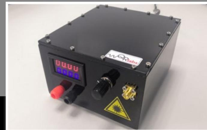
ДРАЙВЕР ЛАЗЕРНОГО ДИОДА
