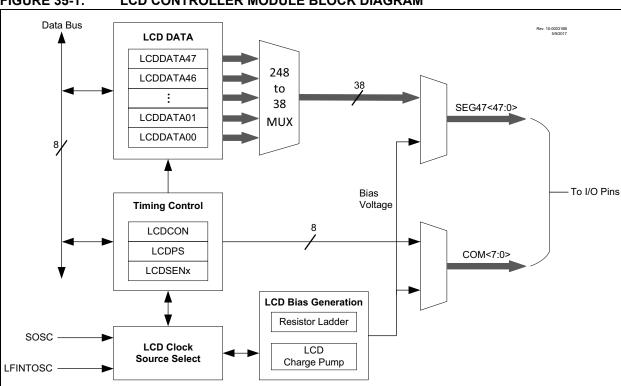
FIGURE 35-1: LCD CONTROLLER MODULE BLOCK DIAGRAM
