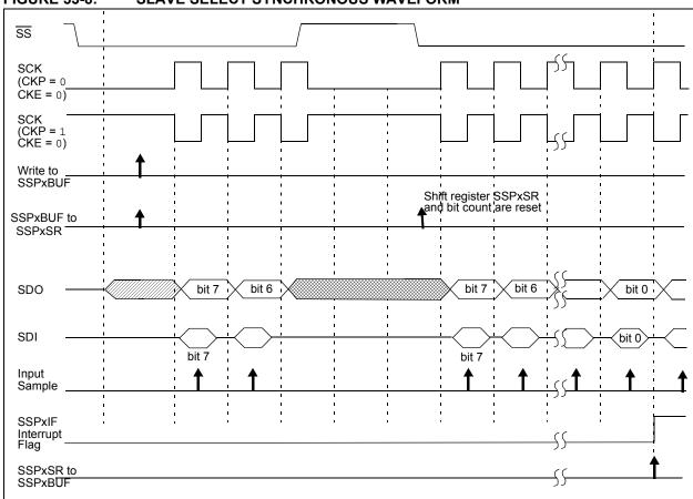
FIGURE 33-9: SPI MODE WAVEFORM (SLAVE MODE WITH CKE = 0)
