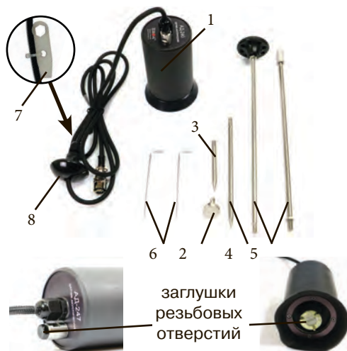
Рис.2 Состав акустического датчика
