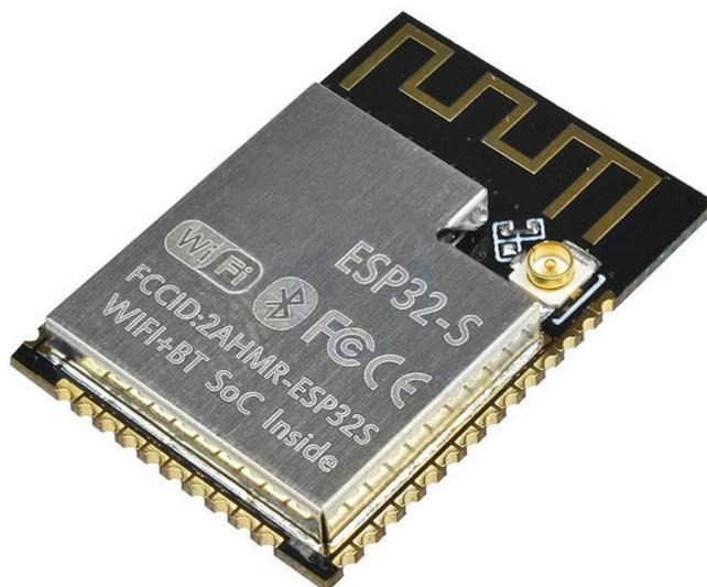
Под металлической крышкой модуля [ESP32-S](#) расположена система на кристалле SoC [ESP32-D0WDQ6](#) с тактовой частотой до 240 МГц, Flash-память на 4 МБ и другая электронная обвязка. Также в кристалл ESP32-D0WDQ6 встроен датчик температуры, датчик Холла и контроллер сенсорного ввода. Поддерживаются беспроводные стандарты связи Wi-Fi 802.11 b/g/n (2,4 ГГц) и протокол Bluetooth v4.2 с BLE.
