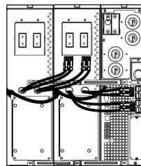
6. Установите на место верхние крышки и закрепите их винтами, снятыми в п. 1.
