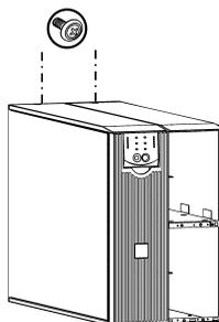
*Монтаж и подключение батарей и закрепление лицевой панели*
