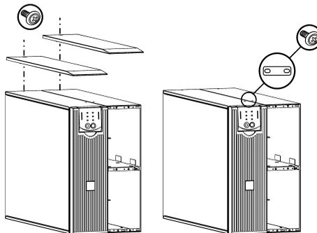
2. Установите скобу крепления ИБП и внешней аккумуляторной батареи (винты прилагаются).
