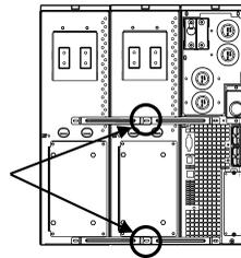
4. Подключите зелёно-желтые провода заземления (винты включены в комплект поставки) как показано на нижеприведенных рисунках.
