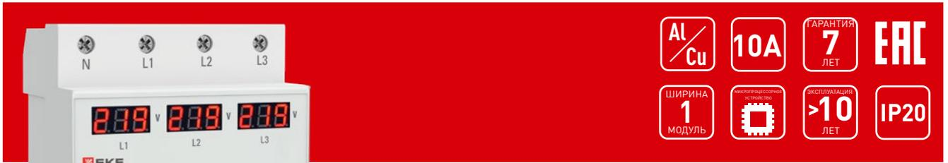
Реле выбора фаз RVF-3-63A EKF предназначено для питания однофазной нагрузки 230В/50(60) Гц от трехфазной сети. Прибор управляется микроконтроллером, который анализирует напряжение в электросети и отображает его на цифровых индикаторах. Реле переключает питание однофазного потребителя в зависимости от наличия и качества фазного напряжения на проводниках L1, L2 и L3. Наиболее приоритетным является питание нагрузки от фазного проводника L1, менее приоритетным – от L3.
