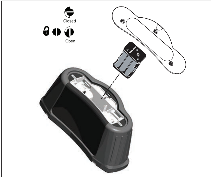
Figura 24. Sostituzione delle batterie
