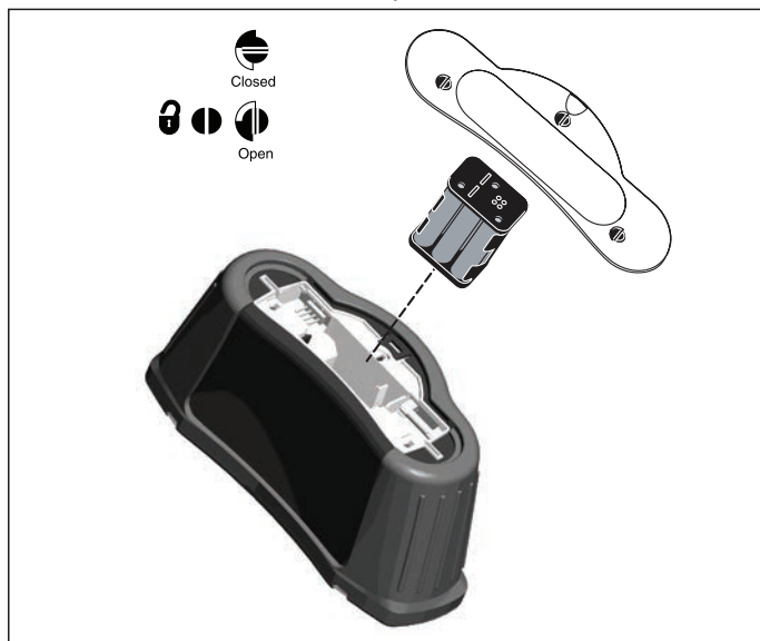
Figure 24. Remplacement des piles
