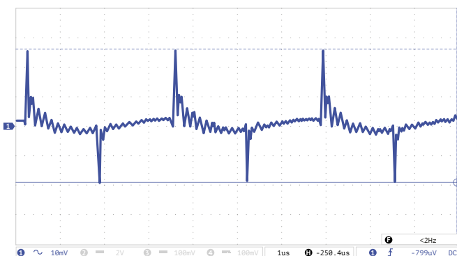
Рис. 6 (в). Осциллограмма пульсаций выходного напряжения.
