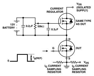
FIGURE 16. GATE CHARGE TEST CIRCUIT
