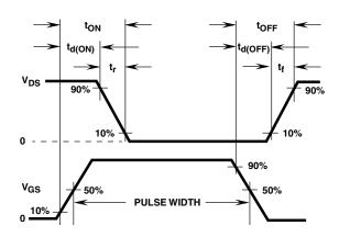
FIGURE 15. RESISTIVE SWITCHING WAVEFORMS
