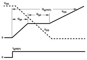
FIGURE 17. GATE CHARGE WAVEFORMS
