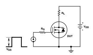
FIGURE 14. SWITCHING TIME TEST CIRCUIT
