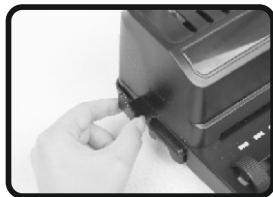
Рис.: 2 Установите регулятор глубины перфорации в положение от 2 до 5 мм
