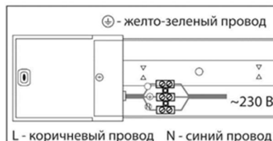
Рисунок 4. Подключите светильник к электрической сети ~230 В с помощью клеммной колодки (в комплект не входит).
