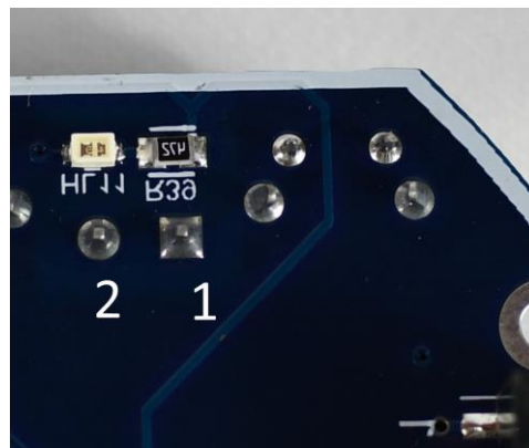
Рис. 1.3 Пример нумерации контактной группы разъема
