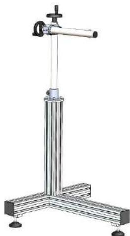
Стойка с основанием «Т» шириной 700 и глубиной 680 мм изготавливается из анодированного алюминия, нержавеющей стали и пластика позволяя устанавливать оборудование в помещениях любой влажности. Основание стойки имеет регулируемые опоры или колеса с блокировкой, с помощью которых стойку можно легко перемещать и жестко фиксировать в месте установки. Ходовые винты регулировок аппликатора с трапециевидной резьбой позволяют изменять положение аппликатора без чрезмерных усилий.
